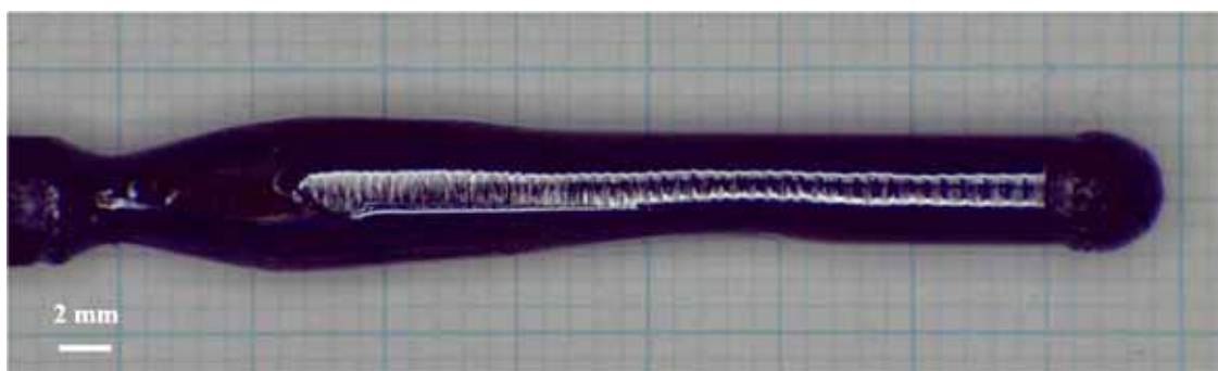
図 3.1.2 化学量論組成 \text{YMnO}_3 単結晶
