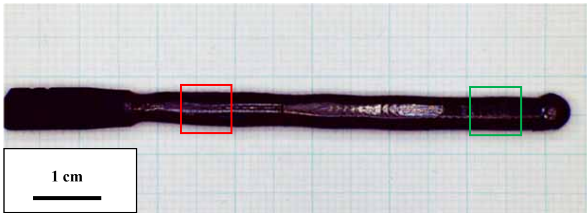
図 3-2-1 Ar:O 2 =1:1 (2 atm)雰囲気で作成した単結晶の全体写真 (赤枠：育成初期、緑枠：終端部)
